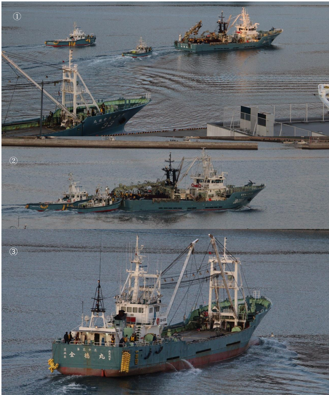
ホテルの窓から見えた旋網漁船団の出港風景です。①旋網漁船が まきあみ 出港し、2 隻のレッコボートが追いかける ②レッコボートが追いつき、旋網漁船の船尾に接続 ③漁場から漁獲物を運ぶ運搬船が続いて出港していきま した。
